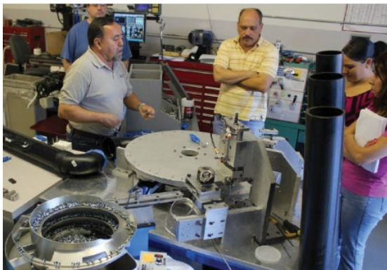
Ein PHC-Kaizen-Team arbeitet zusammen, um eine automatisierte Arbeitszelle zu entwickeln, die das neue S8-Messer produzieren wird.
